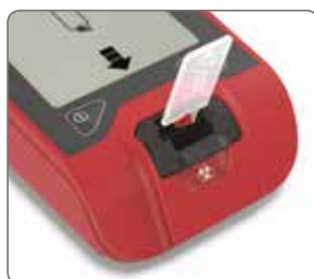
2 Microcuvette in analyser plaatsen.
